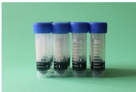
Рис. 2.1. Экспресс-тест из питательной среды в пластиковой пробирке для выявления паразитарной и бактериологической среды в воде
